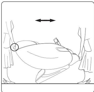
Для перемещения массажного кресла требуются 2 человека. Один должен держаться за подножку и поднимать, как показано на рисунке. Другой должен наклонить спинку кресла таким образом, чтобы ролики, расположенный сзади кресла, достали до пола. Переместите массажное кресло с помощью роликов. После перемещения в нужное место медленно и осторожно поставьте массажное кресло.
